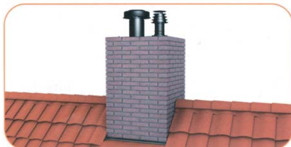
4. Werk de dakbedekking strak tegen de kolom aan en verkleef het Wakaflex aan de droge(!) pannen. Veranker de schoorsteen binnenin de woning met de draadeinden en U-profielen.
