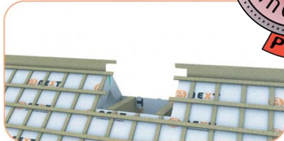
1. Maak een sparing in het dakvlak en stel de onderconstructie (bijvoorbeeld een balklaag) op hoogte.
